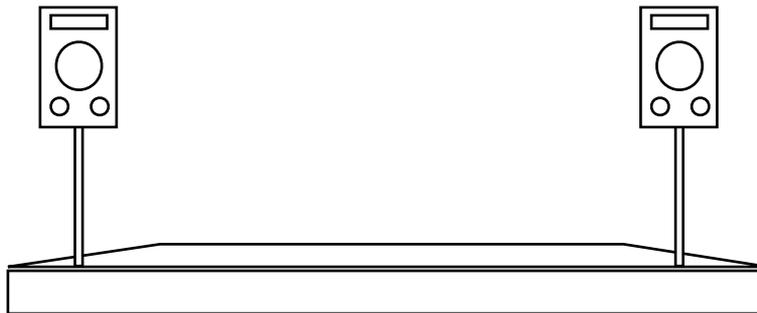
Attention des placer les HP légèrement au dessus des spectateurs des premiers rangs à l'aide de pieds de HP, en suspendant ceux ci à une barre ou en les accrochant à des attaches murales. Ce type de système peut être dérangeant pour le voisinage puisque les vibrations sont transmises par les murs.
