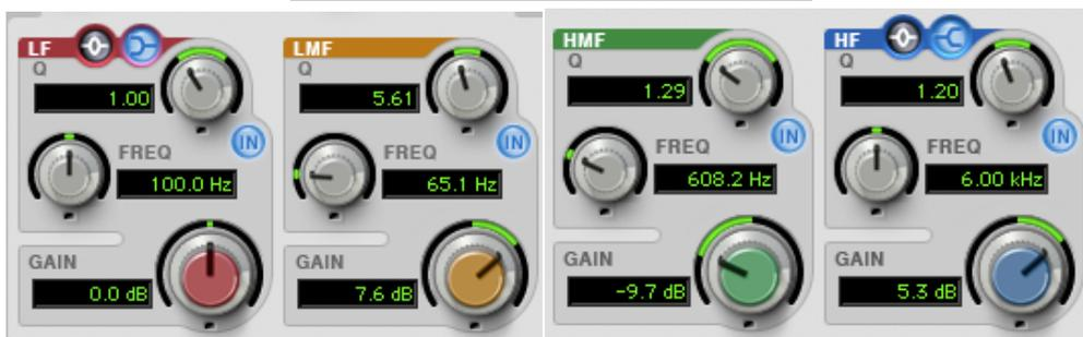
Si on ne manipule pas bien une égalisation full-paramétrique, il est possible de simplifier celle-ci en réglant le "Q" sur une valeur moyenne, et ainsi travailler avec une égalisation semi-paramétrique, car, pour une égalisation semi-paramétrique, le Q est fixe et moyen.
